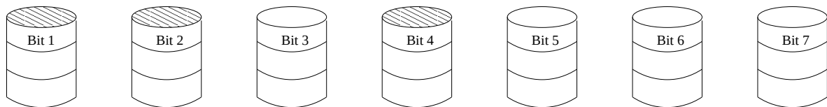
Abbildung 16.7: RAID-System für Level 2 mit 3 Paritätsbits
