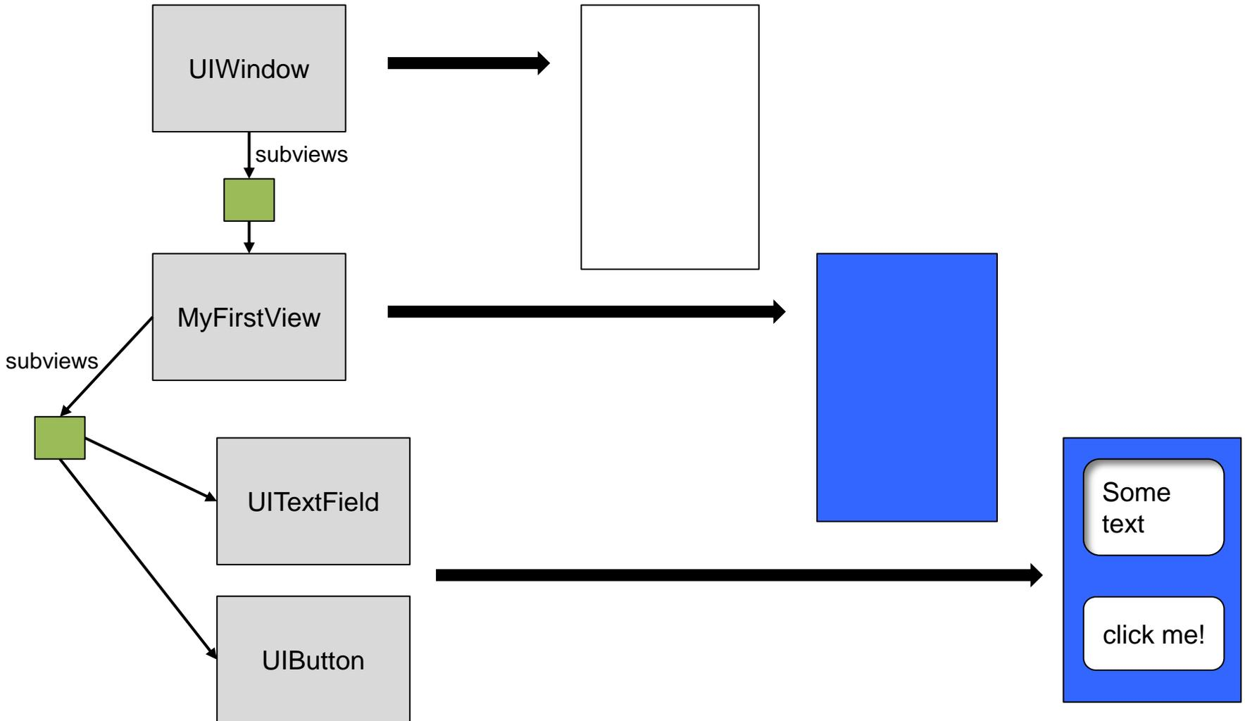
Abbildung der Hierarchie mit genau einem Verweis auf Eltern-Instanz (Superview)
