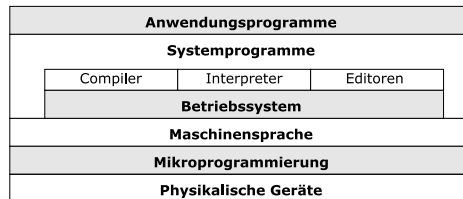
Abbildung 1.1: Logische Hierarchie in einem Rechner
