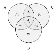
(i) Berechnen Sie unter Verwendung des folgenden Venn-Diagramms die Prüfbits für das Datenwort **0011**. Verwenden Sie dazu **gerade Parität**. Tragen Sie zunächst die Datenbits in die für die Berechnung sinnvollen (Schnitt-)Mengen ein.
