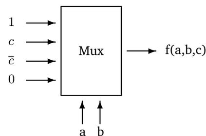
Geben Sie analog zum Beispiel eine Belegung der Eingänge eines 4-Eingaben-Multiplexers ( $I_0, \dots, I_3$ ) sowie der Steuerleitungen  $S_1$  und  $S_2$  an, sodass dieser die Boolesche Funktion
