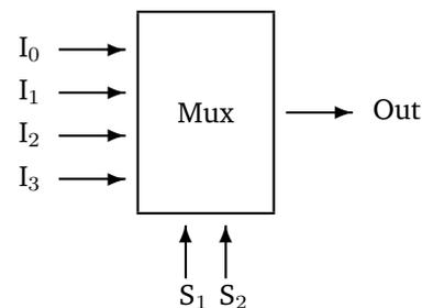
Mit Hilfe eines 4-Eingaben-Multiplexers kann die Boolesche Funktion  $f(a, b, c)$  dargestellt werden, indem dessen Eingänge bzw. Steuerleitungen wie folgt belegt werden.
