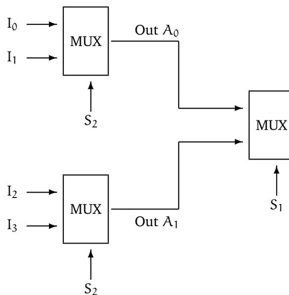
Abbildung 7.15: 4-Eingaben-Multiplexer durch 3 2-Eingaben-Multiplexer realisiert
