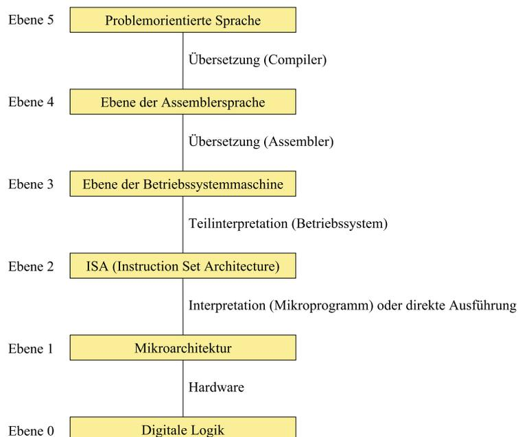
Abbildung 19.2: Die Struktur eines Computers mit 6 Ebenen
