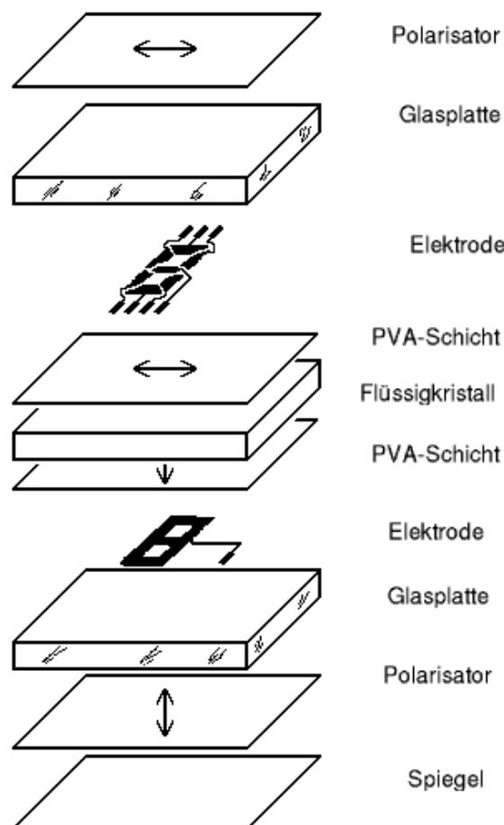
Abbildung A.4: Aufbau eines LCD
