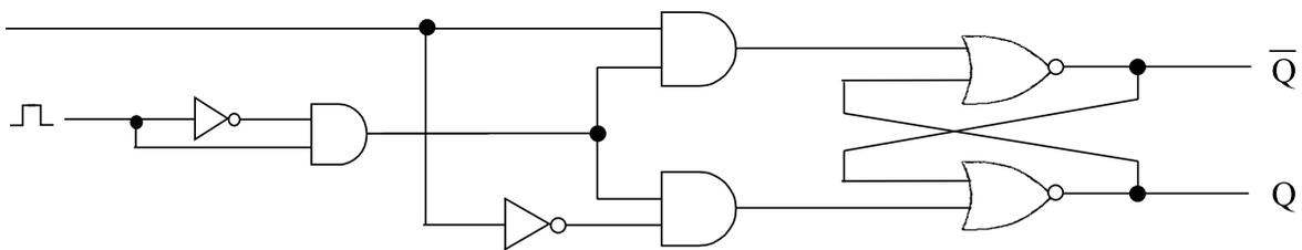
Abbildung 9.11: D-Flip-Flop-Schaltung
