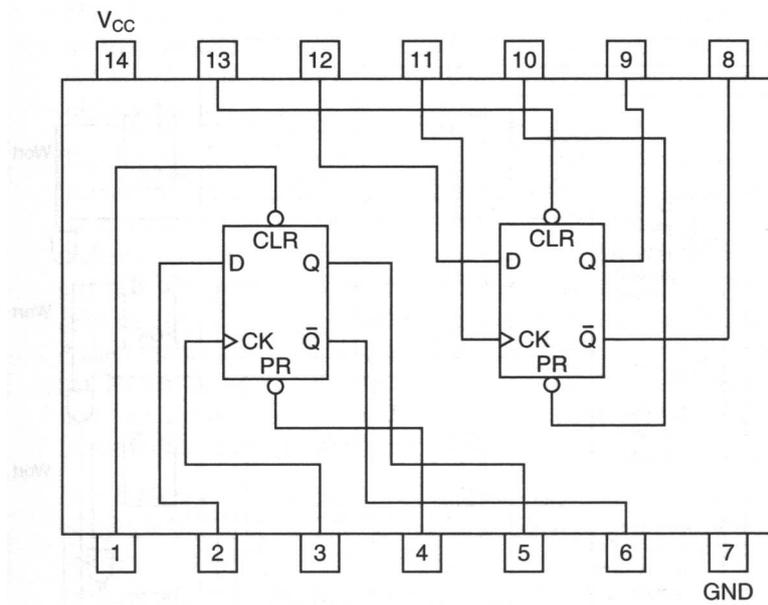
Abbildung 9.14: 2-Bit-Flip-Flop
