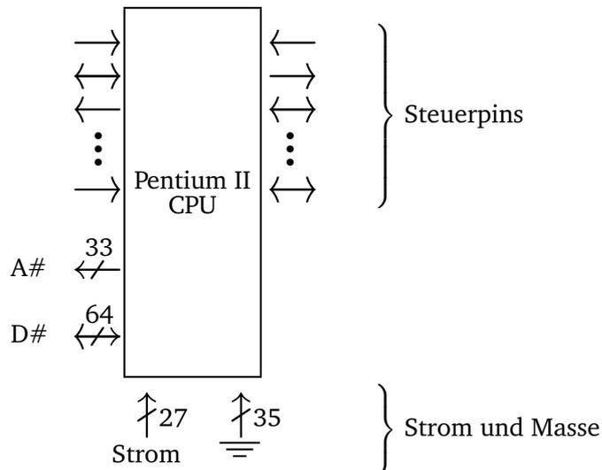
Abbildung 3.2: Logisches Pinout des Pentium II
