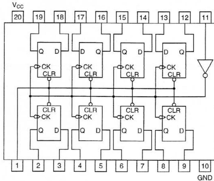
Abbildung 9.15: 8-Bit-Flip-Flop
