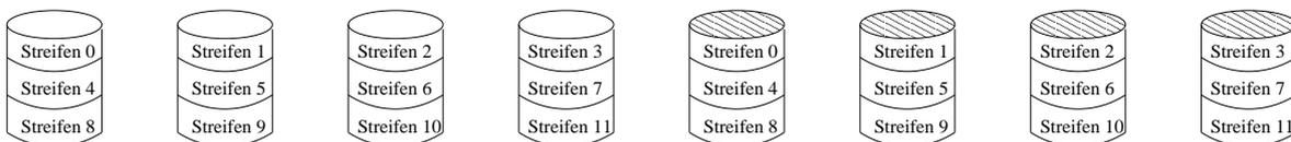
Abbildung 16.6: RAID-System für Level 1 mit 4 Primär und 4 Sekundärplatten
