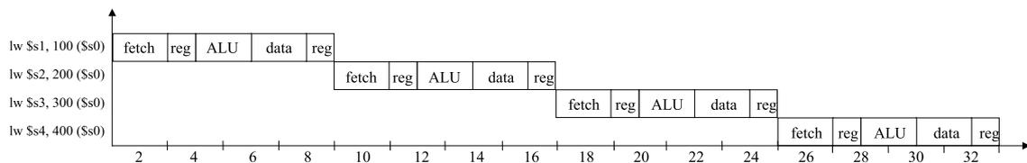
Abbildung 18.1: sequentielle Ausführung
