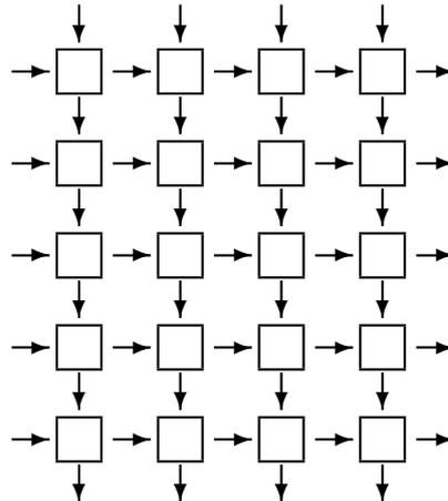
Da die gegebene Schaltfunktion 3-stellig ist und damit nur drei der fünf Inputs auf der linken Seite benötigt werden, „sperren“ wir die beiden unteren Inputs durch Anlegen einer 0. Die vier oberen Inputs „neutralisieren“ wird durch Anlegen von Einsen. Von den Outputs benötigen wir genau zwei, und zwar die unteren beiden auf der rechten Seite.
