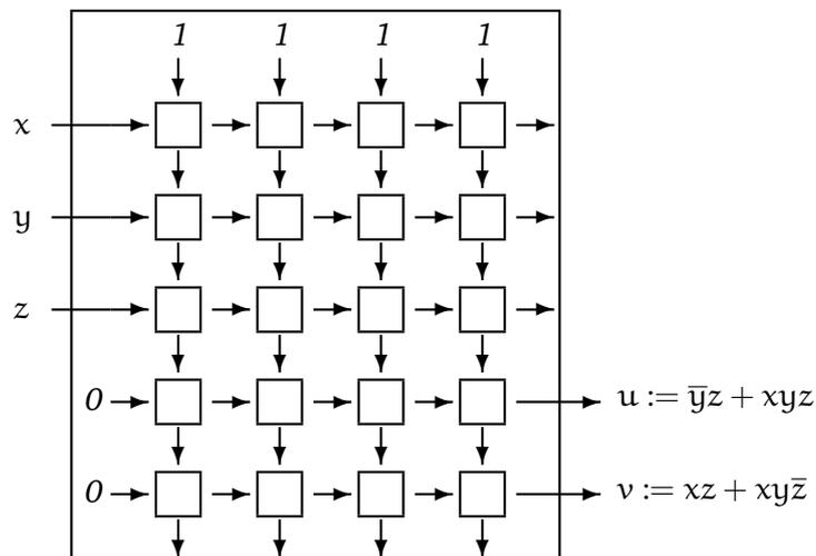
Die vier Spalten des Felds werden nun zur Erzeugung der vier Produkte  $\bar{y}z$ ,  $xyz$ ,  $xz$  sowie  $xy\bar{z}$  verwendet. Diese sind dann noch geeignet zu summieren und an die Ergebnis-Ausgänge weiterzuleiten.
