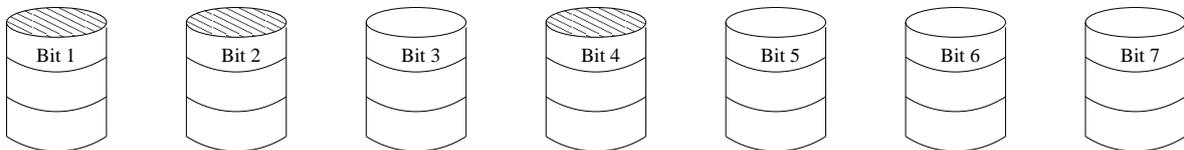
Abbildung 16.7: RAID-System für Level 2 mit 3 Paritätsbits
