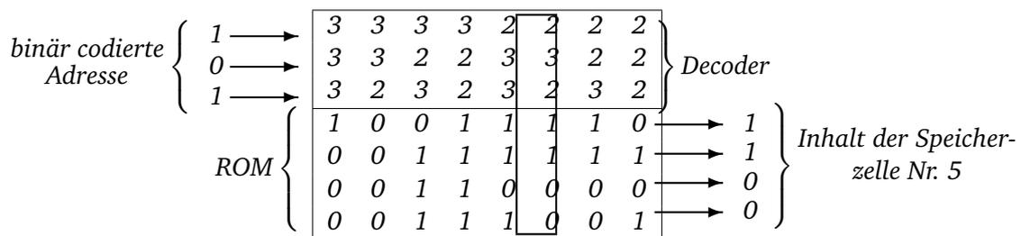
Durch Eingabe von  $5_{10} = 101_2$  wird in der Spalte Nr. 5 der AND-Gatter eine Eins erzeugt und an den unteren Teil der PLA weitergeleitet. Im Decoder passiert folgendes:
