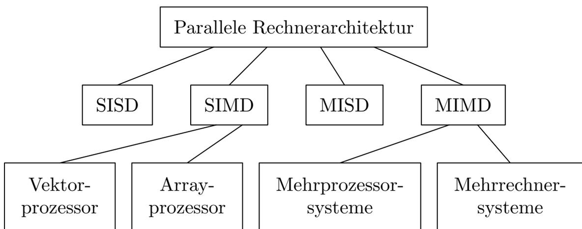
Abbildung 20.5: Parallele Rechnerarchitektur
