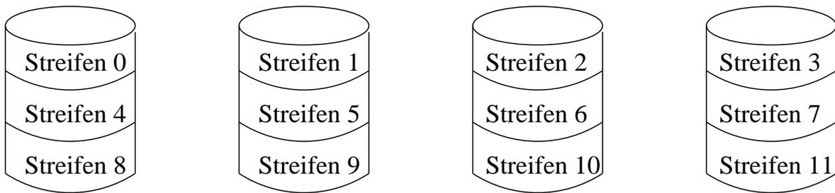
Abbildung 16.5: RAID-System für Level 0, das aus 4 Einzelplatten besteht
