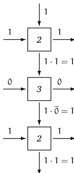
In allen anderen Spalten wird mindestens ein Baustein den Wert 0 erzeugen, und damit ist das ganze Produkt gleich Null. Damit wird genau der Inhalt der zugehörigen darunterliegenden Speicherzelle als Ergebnis ausgegeben. Alle anderen Inhalte der Speicherzellen werden mit dem Faktor 0 aufaddiert, d.h. spielen keine Rolle.
