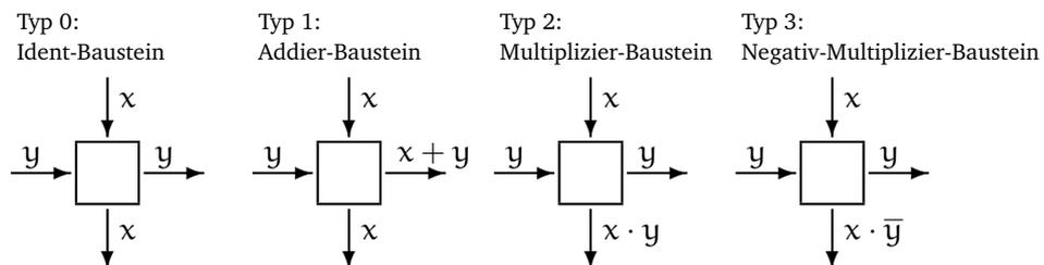
Abbildung 7.18: verschiedene Gitterpunkt-Typen
