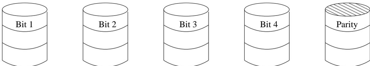
Abbildung 16.8: RAID-System für Level 3 mit einem Paritätsbit
