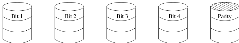
Abbildung 12.8: RAID-System für Level 3 mit einem Paritätsbit
