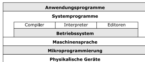
Abbildung 1.1: Logische Hierarchie in einem Rechner
