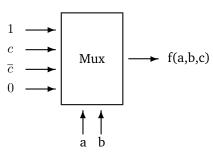
Geben Sie analog zum Beispiel eine Belegung der Eingänge eines 4-Eingaben-Multiplexers  $(I_0, \dots, I_3)$  sowie der Steuerleitungen  $S_1$  und  $S_2$  an, so dass dieser die Boolesche Funktion
