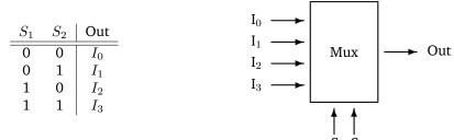
Mit Hilfe eines 4-Eingaben-Multiplexers kann die Boolesche Funktion f(a,b,c) dargestellt werden, indem dessen Eingänge bzw. Steuerleitungen wie folgt belegt werden.
